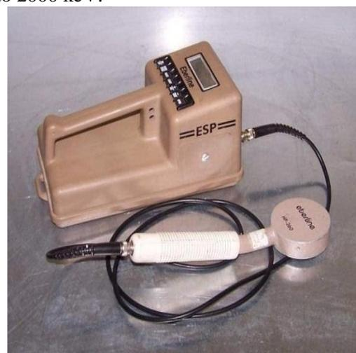
Fig. (5): (a) ESP-1 gamma survey meter
